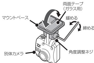
\* 別体カメラの上下切りかえスイッチを↑、正像鏡像切りかえスイッチをM（鏡像）に変更してください。【→P20】
