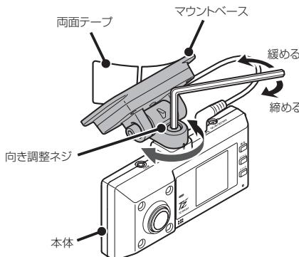
3 付属の六角レンチで角度調整ネジをまわして、本体の角度を調整する。
